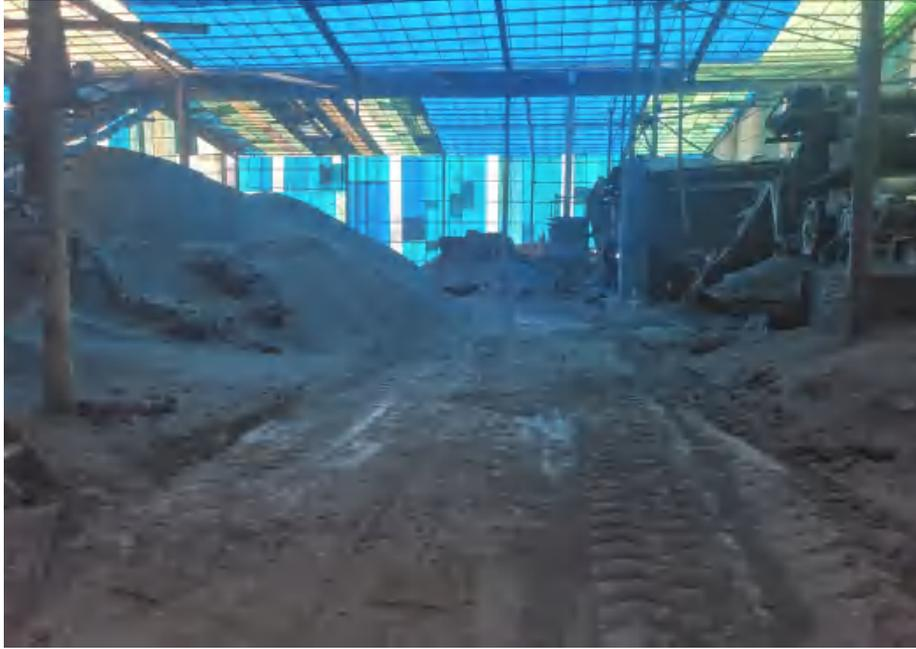
图 6-5 破碎车间破碎控制室外侧地面积尘较多
