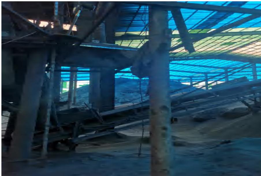
图 6-6 破碎车间对辊控制室外侧地面积尘较多
