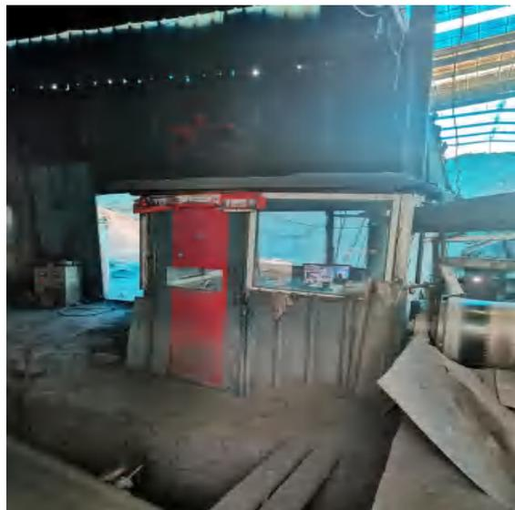
图 5-4 破碎车间设置的密闭对辊控制室
