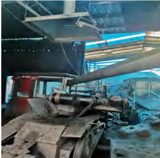
图 5-5 对辊机输送带上方设置的吸尘罩
